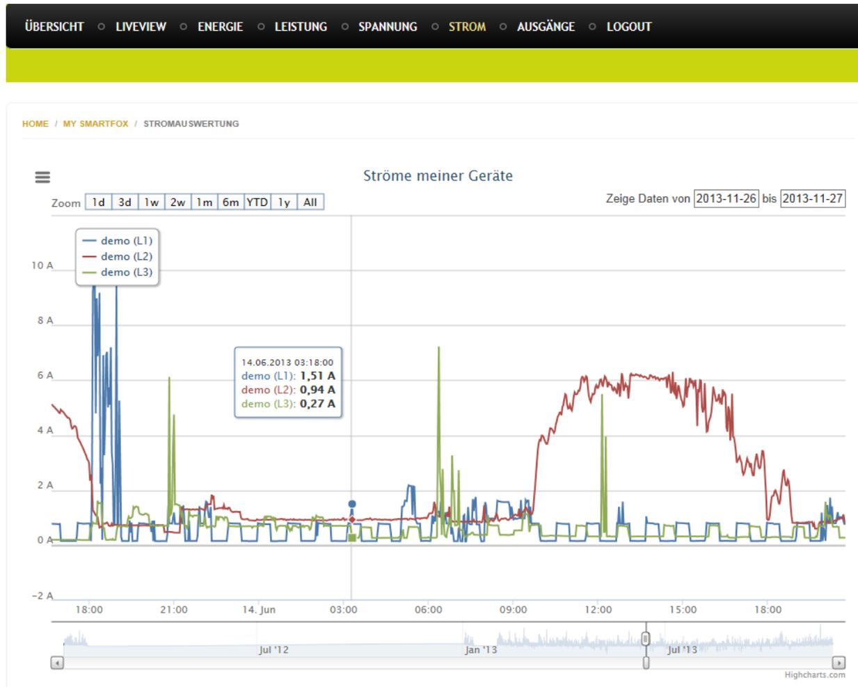
Durch das schnelle und genaue Datenlogging von Spannung, Strom und Leistung werden fehlerhafte Geräte bis hin zur falsch eingestellten Heizung analysiert.
